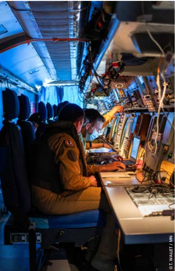
L'équipage de L'ATL2 se familiarise avec les nouveaux équipements du Standard 6, comprenant nouveaux écrans tactiles, nouvelles interfaces et nouvelle caméra, pendant un vol d'essai.
